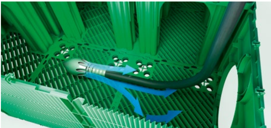
Innovative Seiten- und Bodenwandkonstruktion - schräge Rippen lenken bei der Reinigung den Druckwasserstrahl um wodurch eine Beschädigung des Geotextils verhindert wird
